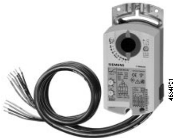
**Elektrické rotační servopohony, spojitý řídící signál 0...10 V ss , jmenovitý kroutící moment 5 / 10 Nm, napájecí napětí 24 V ~, automatická adaptace úhlu otáčení, zpětnovazební výstupní signál pro indikaci polohy 0...10 V ss , pracovní rozsah mechatnicky nastavitelný mezi 0...90°, připojovací kably o délce 0,9 m.**
